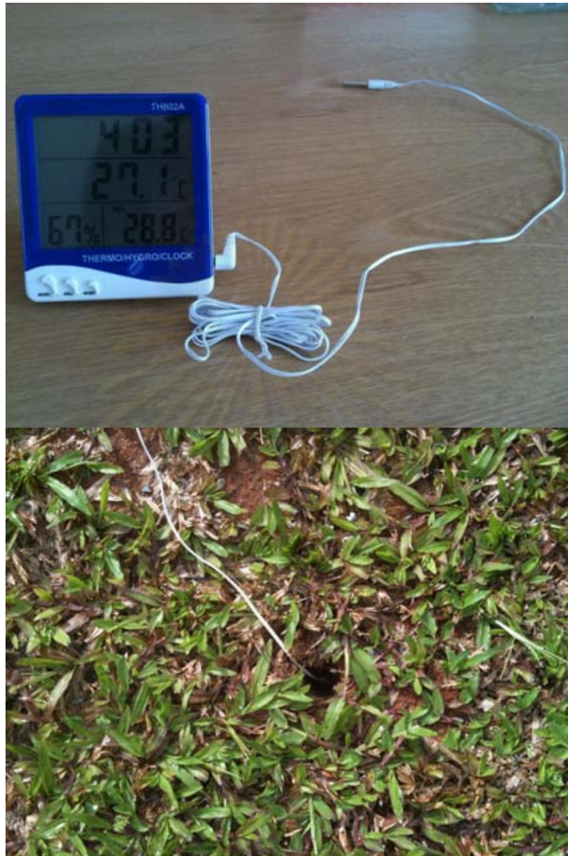
ภาพที่ 3.9 : เครื่องวัดอุณหภูมิและความชื้นสัมพัทธ์ แบบวัดได้ทั้งภายในด้วยตัวเครื่อง และภายนอกด้วยสายต่อเชื่อมระบบส่วนปลายเป็น censer
