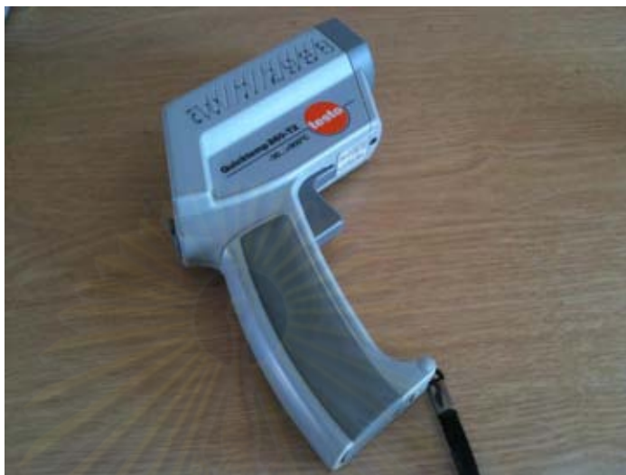
ภาพที่ 3.7 เครื่องมือวัดอุณหภูมิ Thermo gun
