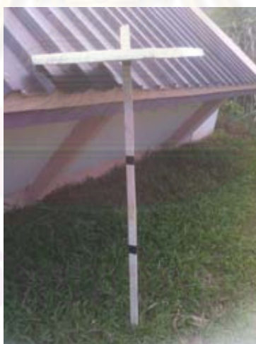
ภาพที่ 3.8 : แท่งไม้สำหรับปักลงดินเพื่อบอกระยะความสูง ส่วนปลายติดตั้งเครื่องวัดอุณหภูมิไว้ตามระยะความลึกต่างๆ
