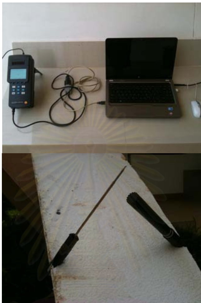
ภาพที่ 3.10 : เครื่องวัดอุณหภูมิ ความชื้นสัมพัทธ์ และความเร็วลม ระบบแยกสายต่อเชื่อมกับ ตัวเครื่องหลักที่ทำหน้าที่บันทึกข้อมูล Data logger และส่งผ่านข้อมูลเข้าคอมพิวเตอร์เพื่อ ประเมินผล
