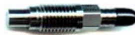
รูปที่ 5-18 Pressure Transducer สำหรับวัดความดัน เชื้อเพลิงที่ทางเข้าหัวฉีด
