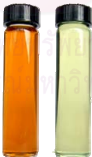
รูปที่ 2-7 รูปน้ำมันที่ใช้ในการวิจัย เปรียบเทียบระหว่างน้ำมันปาล์มไบโอดีเซล(ภาพซ้าย) และน้ำมันดีเซล(ภาพขวา)
