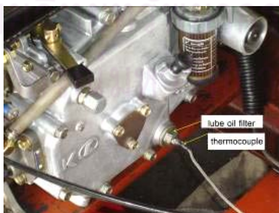
รูปที่ 5-5 การติดตั้งตำแหน่งของเทอร์โมคัปเปิลที่ตัวกรองน้ำมันหล่อลื่น
