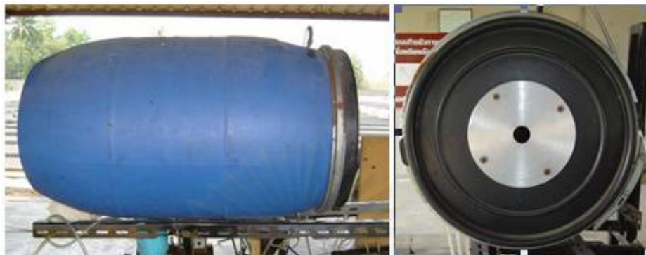
รูปที่ 5-8 ถังพักอากาศและการติดตั้ง Orifice Plate
