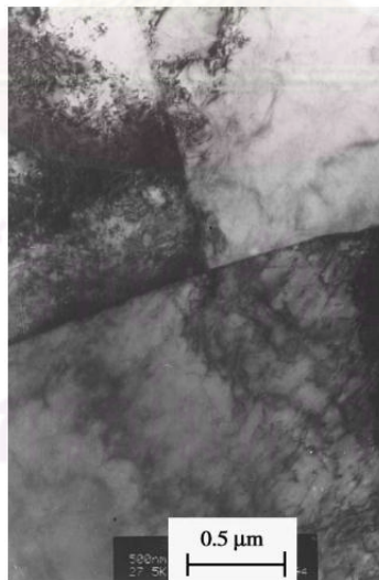
รูปที่ 2.11 ภาพจากกล้องจุลทรรศน์อิเล็กตรอนแบบส่องผ่าน วัสดุที่ผ่านการใช้งานหลังการอบอ่อน เป็นเวลา 0.5 ชั่วโมง ที่อุณหภูมิ 1423 K แสดงให้เห็นแต่โลหะเนื้อพื้นและขอบเกรน [7]
