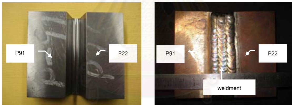
ก) ตัวอย่างชิ้นงานก่อนเชื่อม
