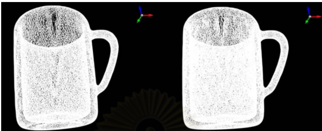
รูปที่ 3.3 วัตถุสามมิติก่อนการแบ่งเส้นเชื่อมที่ยาวเกินไป (ซ้าย) และหลังการแบ่งเส้นเชื่อมที่ยาวเกินไป (ขวา)
