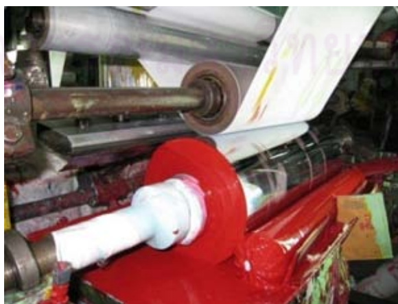
รูปที่ 3.2 การทำให้เกิดภาพลงบนฟิล์มพลาสติกของแม่พิมพ์กราเวียร์
