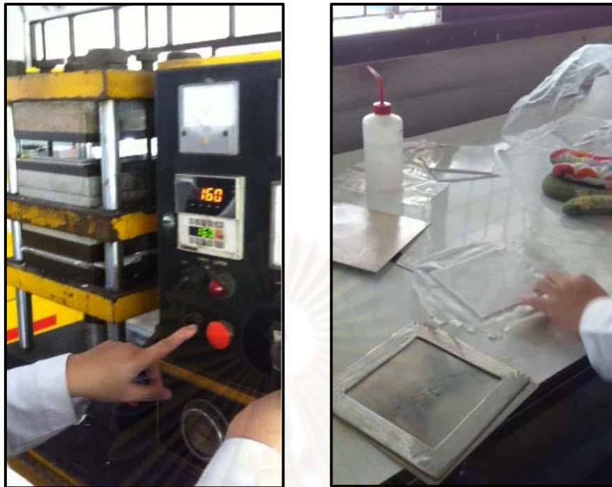
รูปที่ 15 แสดงการการอัดขึ้นรูปชิ้นงาน ด้วยเครื่องอัดขึ้นรูป (Compression Molding)
