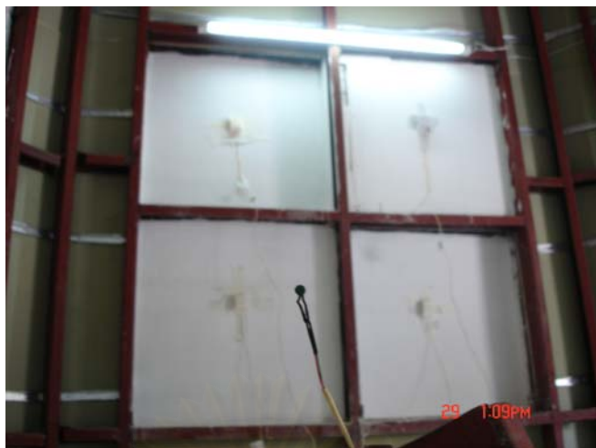
รูปที่ 3.9 การติดตั้งห้ววัดอุณหภูมิกระเปาะแห้ง-เปียกบริเวณภายในของอาคารทดลอง
