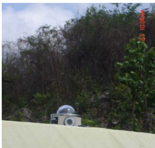
รูปที่ 3.11 การติดตั้งเครื่องวัดพลังงานแสงอาทิตย์และเครื่องวัดความเร็ว-ทิศทางลม
