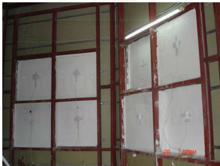
รูปที่ 3.8 การติดตั้งหัววัดอุณหภูมิบริเวณผิวภายในของผนังทดลอง
