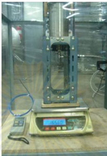
รูปที่ 4-9 แสดงอุปกรณ์การวัดอัตราสิ้นเปลืองน้ำมันเชื้อเพลิง
