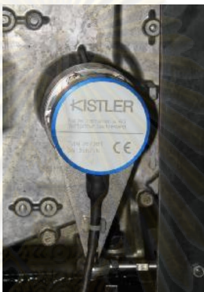
รูปที่ 4-22 แสดง Crank Angle Encoder ยี่ห้อ Kistler รุ่น 2613B
