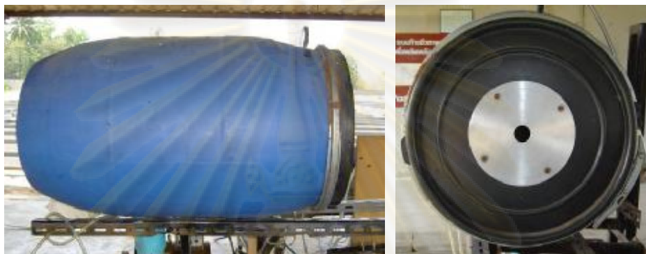
รูปที่ 4-13 แสดงถังพักอากาศและการติดตั้ง Orifice Plate
