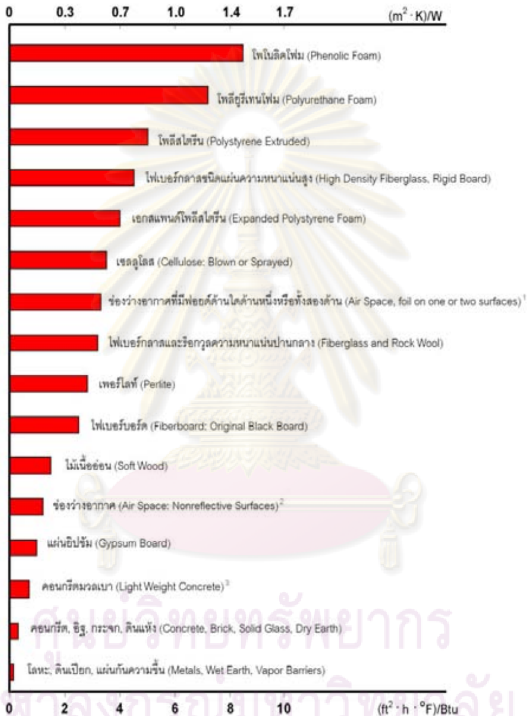
แผนภูมิที่ 2.1 แสดงการเปรียบเทียบค่าความต้านทานความร้อน (R) ของวัสดุต่างๆ ที่ความหนา 1 นิ้ว (สุนทร บุญญาธิการ, 2542ข: 170)
