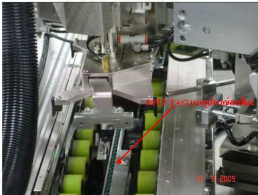
รูปที่ 6.12 แสดงการลำเลียง RFID TAG
