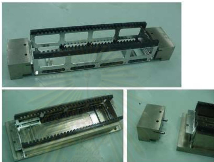
รูปที่ 5.10 อุปกรณ์ที่ออกแบบมาใช้ในการตรวจสอบขนาดของตะกร้าใส่ฝาปิดฮาร์ดดิสก์ไดรฟ์
