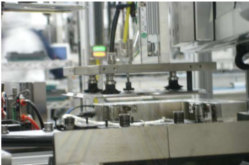
รูปที่ 4.15 ระบบการหยิบจับฝาปิดฮาร์ดดิสก์ไดร์ฟ
