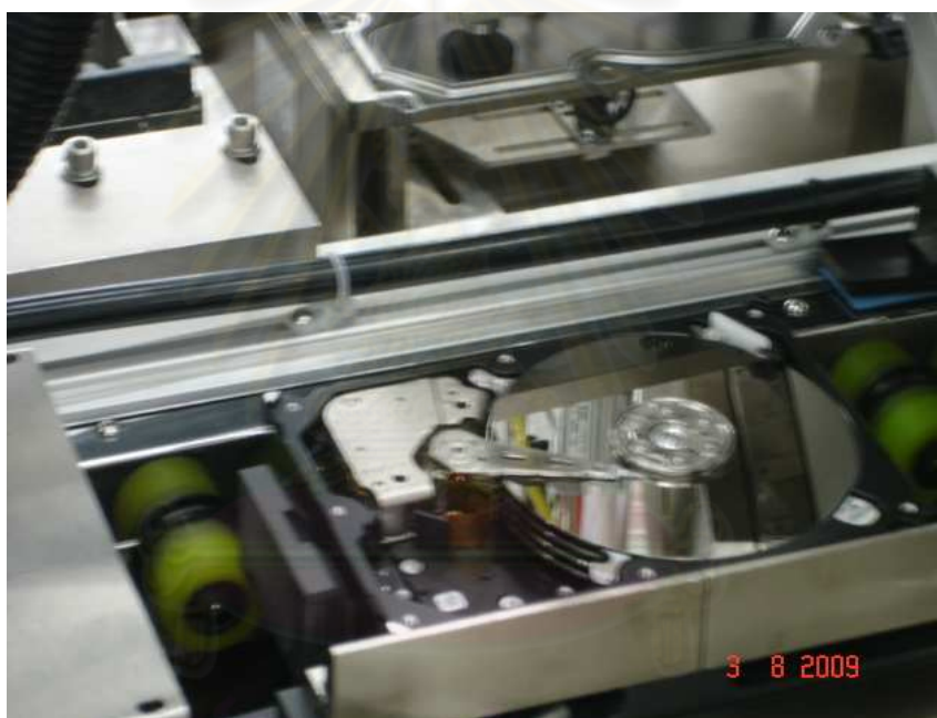
รูปที่ 4.13 แสดงตำแหน่งยกขึ้น ลง ของฐานรองฮาร์ดดิสก์ไดรฟ์เพื่อประกอบกับฝาปิด
