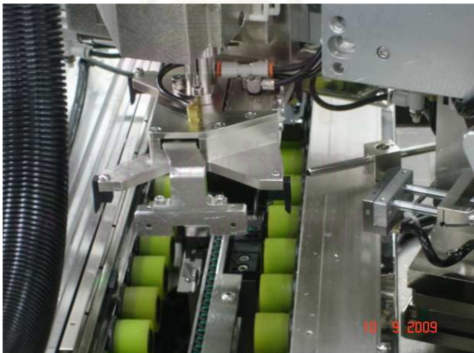
รูปที่ 6.4 แสดงการล่าเสียงและติดตั้ง RFID บนฐานรองฮาร์ดดิสก์ไดรฟ์
