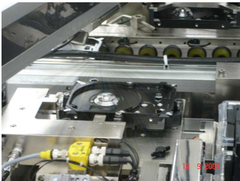
รูปที่ 6.3 แสดงที่ปรับตำแหน่งฐานรองฮาร์ดดิสก์ไดรฟ์
