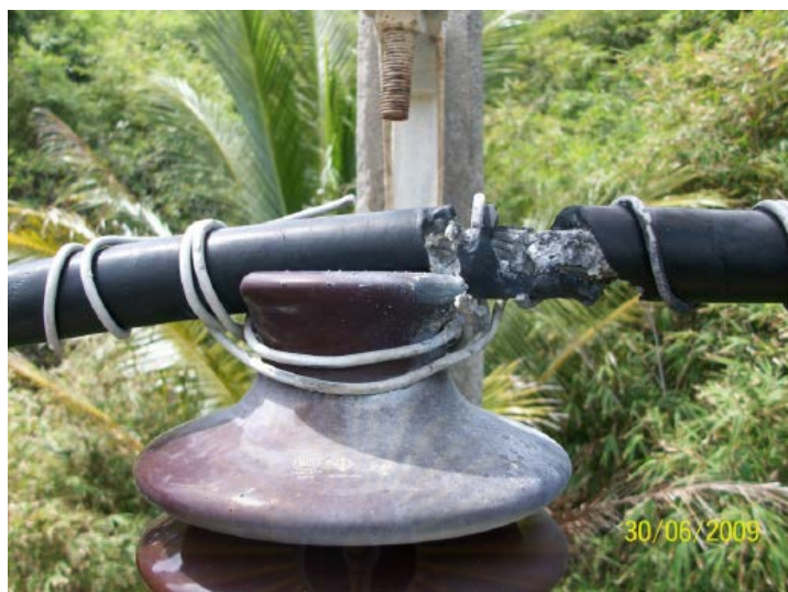
ภาพที่ 1.4 สาย SAC เสื่อมสภาพ และอาจเกิดเหตุการณ์สายขาดในลำดับต่อมาได้
