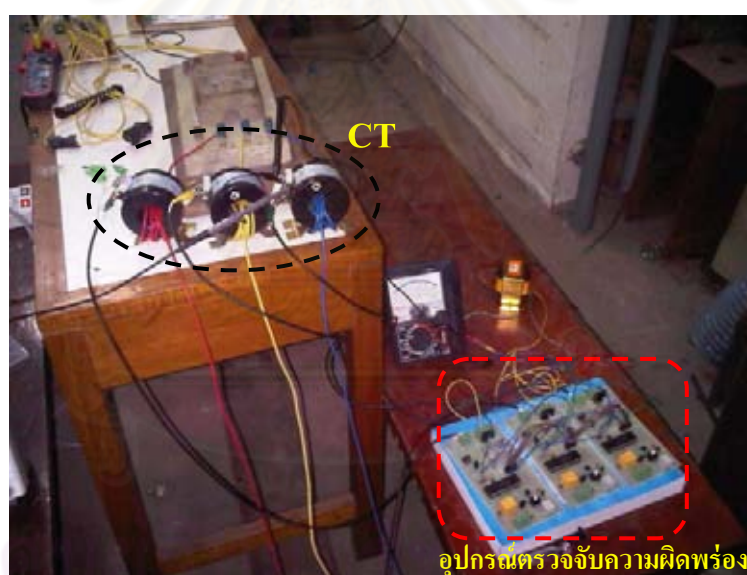
ภาพที่ 4.16 อุปกรณ์ตรวจจับความผิดปกติฯ ที่ต่อร่วมกับระบบจำหน่ายไฟฟ้าจำลอง
