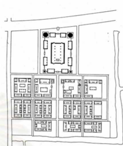
ภาพ 2.6 ลักษณะการจัดแบ่งโครงสร้างผังเขต สังฆาวาสวัดชนะสงคราม กรุงเทพฯ ที่มา:สมคิด จิระทัศน์กุล(2537)
