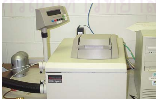
รูปที่ 3.12 เครื่อง differential scanning calorimeter (DSC)
