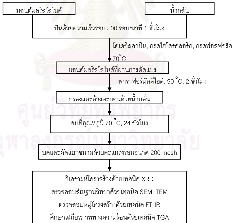
รูปที่ 3.2 ขั้นตอนการเตรียมมอนต์มอริลโลไนต์ชนิดแยกชั้นแผ่น
