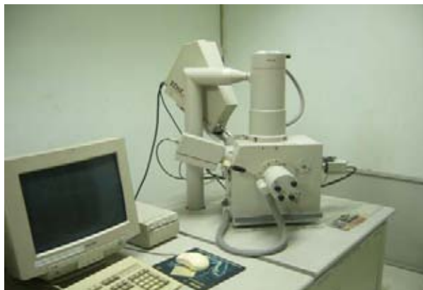
รูปที่ 3.9 กล้องจุลทรรศน์อิเล็กตรอนแบบส่องกราด (SEM)
