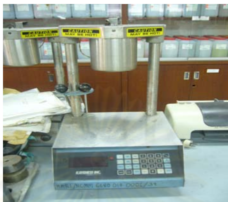
รูปที่ 3.13 เครื่องหาค่าดัชนีการไหล (melt flow index)
