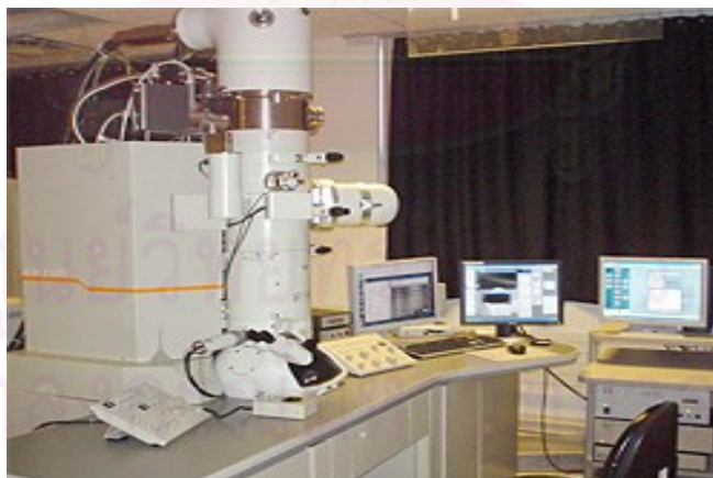
รูปที่ 3.10 เครื่อง transmission electron microscope (TEM)
