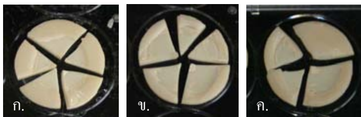
ภาพที่ 28 การเปรียบเทียบความกว้างของชั้นวีเนียร์บริเวณขอบที่เหลือติดกับชั้นคอร์ ภายหลังจากการแตกหัก ในชั้นตัวอย่างกลุ่มที่ 2 (ก) ที่มีชั้นคอร์หนากว่า ซึ่งเหลือกว้างกว่ากลุ่มที่ 3 (ข) และกลุ่มที่ 4 (ค) ที่มีชั้นคอร์บางกว่า
