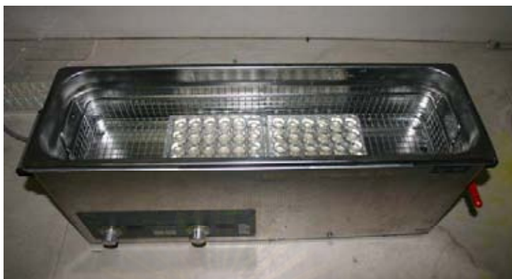
ภาพที่ 12 การทำความสะอาดชิ้นตัวอย่างด้วยเครื่องทำความสะอาดแบบความถี่เหนือเสียง
