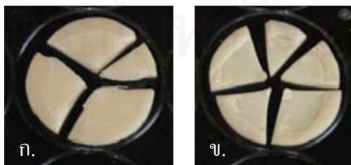
ภาพที่ 29 เปรียบเทียบลักษณะการแตกในแบบที่ 1 ในกลุ่มตัวอย่างที่ 3 แสดงให้เห็น (ก) ชั้นตัวอย่างที่มีรอยร้าวบนชั้นวีเนียร์ พบว่าแนวของรอยร้าวเป็นแนวเดียวกับ (ข) ชั้นตัวอย่างที่มีการแตกลอนของชั้นวีเนียร์
