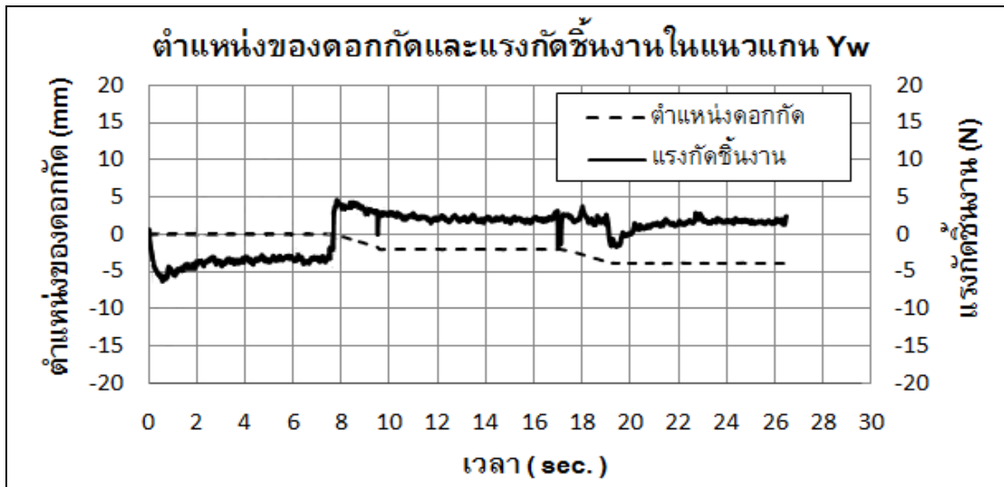
รูปที่ 4.32 ตำแหน่งและแรงกักขังงานในแนวแกน Yw เมื่อทำการกักขังงานเป็นหลุม
