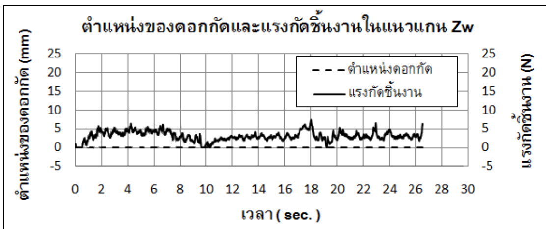
รูปที่ 4.33 ตำแหน่งและแรงกักขังงานในแนวแกน Zw เมื่อทำการกักขังงานเป็นหลุม
