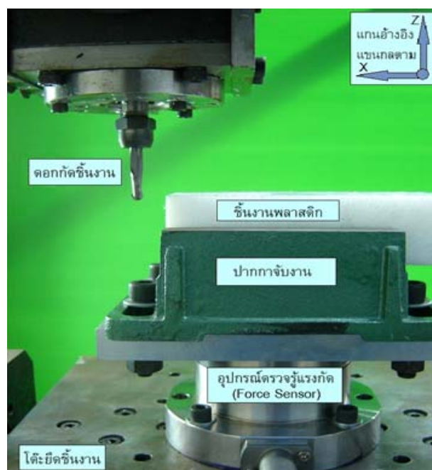
รูปที่ 4.2 การติดตั้งอุปกรณ์ตรวจรู้แรงและการยึดจับชิ้นงาน
