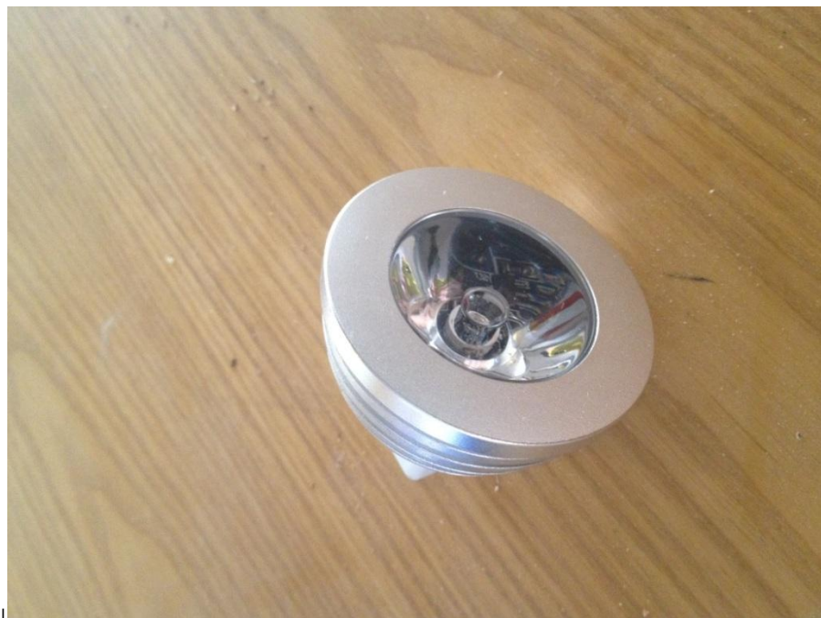
ภาพที่ 3-4 หลอดไฟ LED แบบ warm white 12 V ขั้ว MR16
