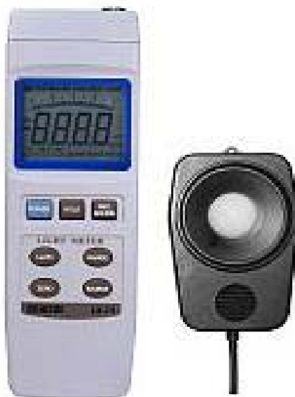
ภาพที่ 3-1 แสดงเครื่องวัดแสงแบบดิจิตอล DIGICON LX-73 (light meter)
