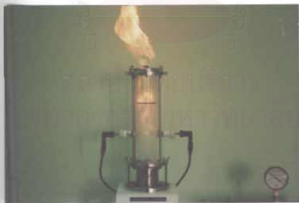
รูปที่ 3.12 ภาพถ่ายของสภาพการระเบิดที่เกิดขึ้นกับผสมแก๊สที่มีความเข้มข้นสูงกว่าค่า LEL.
