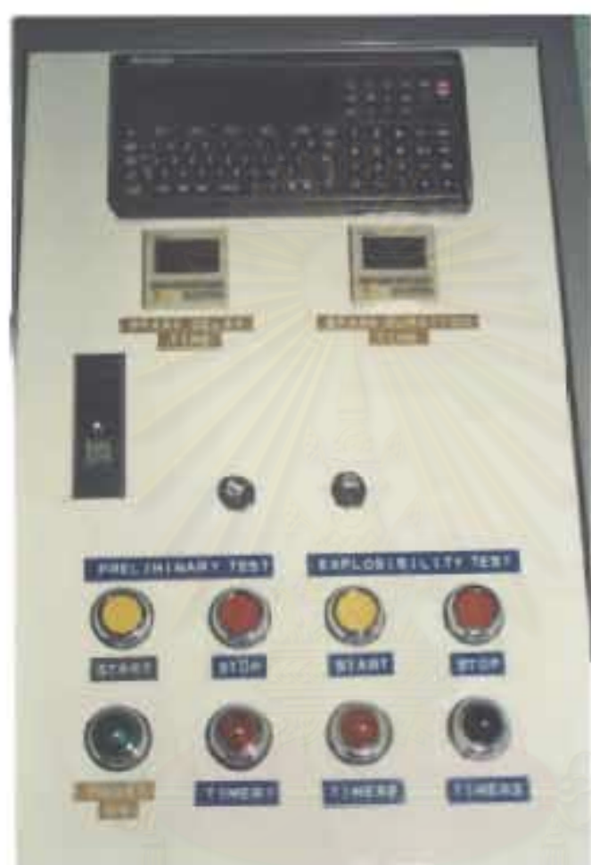
รูปที่ 3.13 ภาพถ่ายของแผงควบคุม ด้านบนของภาพคือเครื่องคำนวณแบบโปรแกรม ซึ่งจะคำนวณและรายงานผลการทดสอบจากข้อมูลที่ป้อนเข้า และเก็บข้อมูลไว้ในหน่วยความจำของเครื่อง
