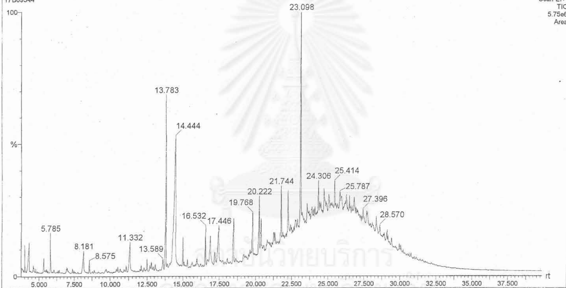
รูปที่ ค1 โครมาโตแกรมที่วิเคราะห์ได้จากตัวอย่างอากาศในบริเวณประตูน้ำ
