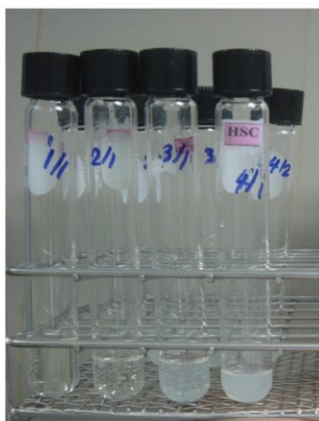
ภาพที่ ข.1.2 สารละลายที่ได้หลังจากตกตะกอนด้วยกรดอะซิติกเข้มข้น 10,20,30 และ 40% เรียงจากซ้ายไปขวา
