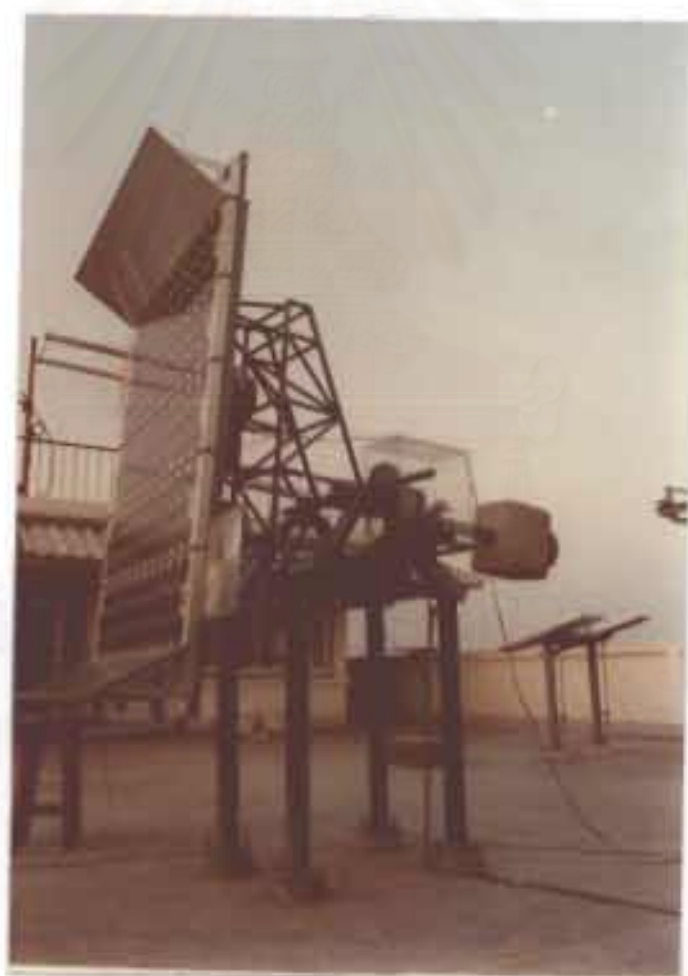
รูปที่ 27 แสดงส่วนประกอบต่าง ๆ ของโครงสร้างรองรับแผงเซลล์ ดวงอาทิตย์ที่สร้างขึ้น
