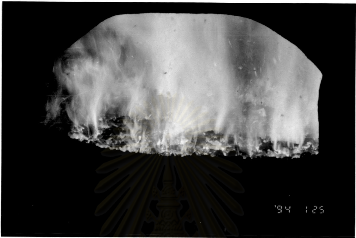
รูปที่ 4.9 ลักษณะเปลวไฟของการเผาไหม้ของถ่านหินปกติในหม้อไอน้ำอุตสาหกรรม
