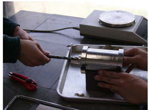
(d) Drilling inner cavity by a drill
