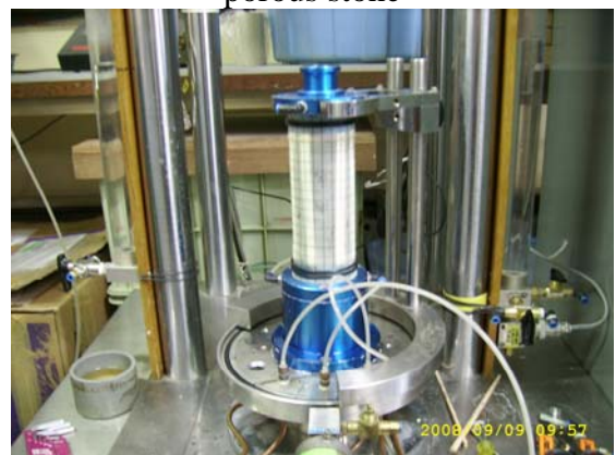
(d) Setting the top cap and enclosing inner and outer membrane
