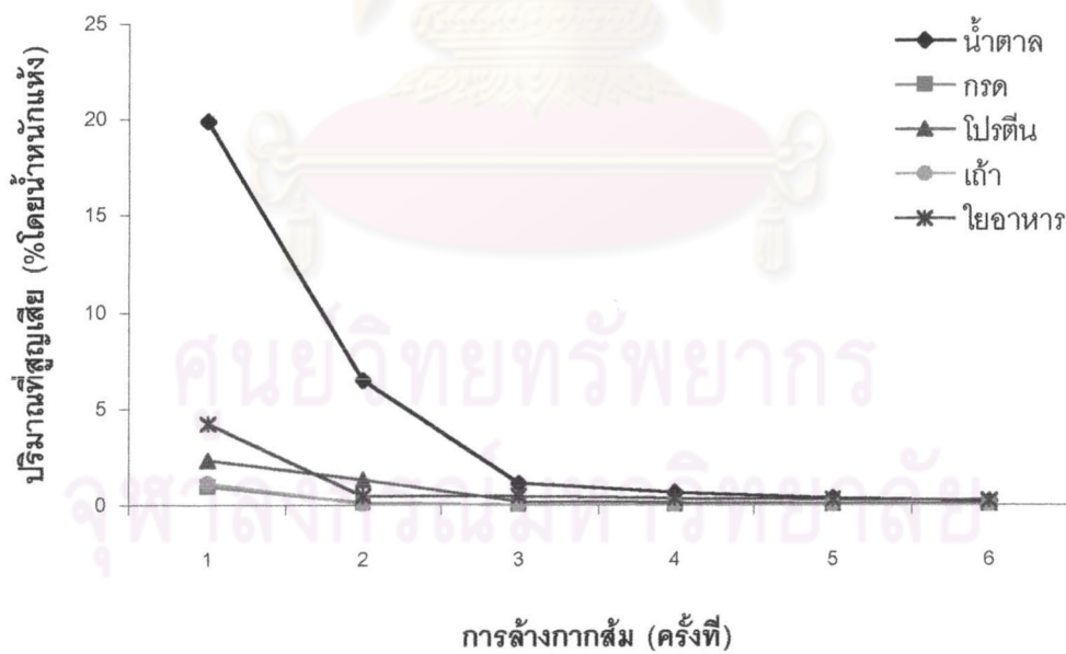
รูปที่ 4.3 องค์ประกอบทางเคมีที่สูญเสียไปในการล้งกากส้มพริ้มองต์ครั้งที่ 1-6
