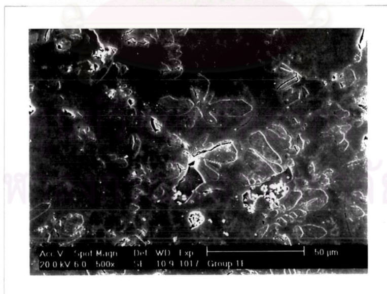
รูปที่ 52 ภาพถ่ายด้วยกล้องจุลทรรศน์อิเล็กตรอนแบบส่องกราดของพอร์ซเลนเฟลด์สปาร์ชนิดโอพอลเลสเซนตีในภาวะการเย็นตัวลงอย่างรวดเร็ว ด้วยกำลังขยายขนาด 500 เท่า
