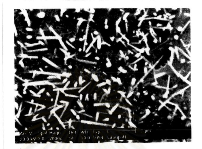
รูปที่ 68 ภาพถ่ายด้วยกล้องจุลทรรศน์อิเล็กตรอนแบบส่องกราดของพอร์ซเลนเฟลด์สปาร์ ชนิดเจือฟลูออโรอะปาไทต์ในภาวะการเย็นตัวลงอย่างรวดเร็ว ด้วยกำลังขยายขนาด 7000 เท่า
