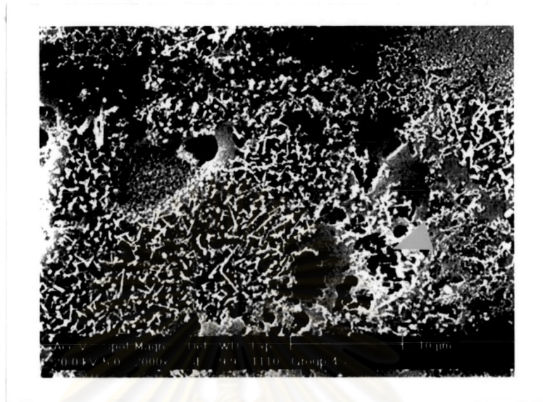
รูปที่ 70 ภาพถ่ายด้วยกล้องจุลทรรศน์อิเล็กตรอนแบบส่องกราดของพอร์ซเลนเฟลด์สปาร์ชนิดเจือฟลูออโรอะปาไทต์ในภาวะการเย็นตัวลงอย่างช้า ด้วยกำลังขยายขนาด 2000 เท่า ลูกศรชี้เหลืองแสดงผลึกยูไซต์ ส่วนผลึกขนาดเล็กสีขาวที่มีลักษณะรูปร่างคล้ายแท่งเข็มคือผลึกฟลูออโรอะปาไทต์
