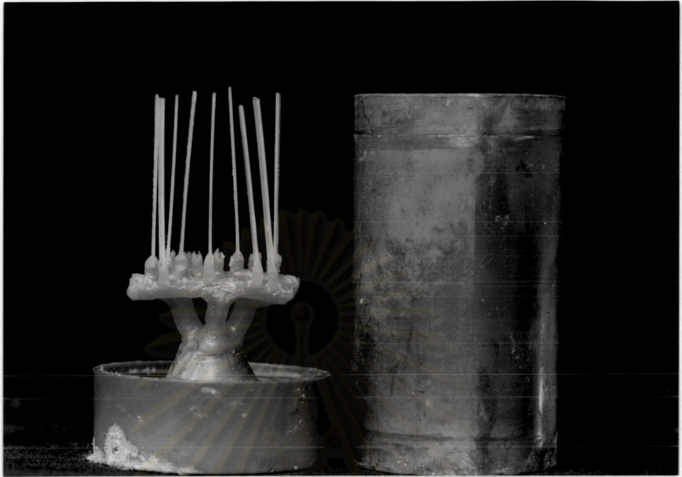
รูปที่ 26 แผ่นพลาสติกยึดกับแกนซี่ผึ้งค้ำรูเท และตัวก่อเบ้า
