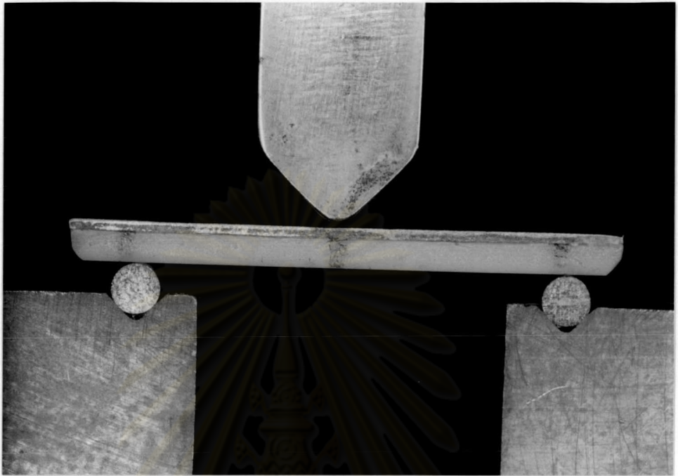
รูปที่ 33 การทดสอบค่ากำลังตัดขวางด้วยเครื่องทดสอบสากล
