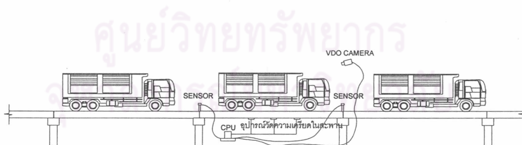
รูปที่ 6.5 กล้องวิดีโอที่ติดตั้งบนโครงสร้างเหล็กข้างสะพานสำหรับเก็บภาพขณะทดสอบ
