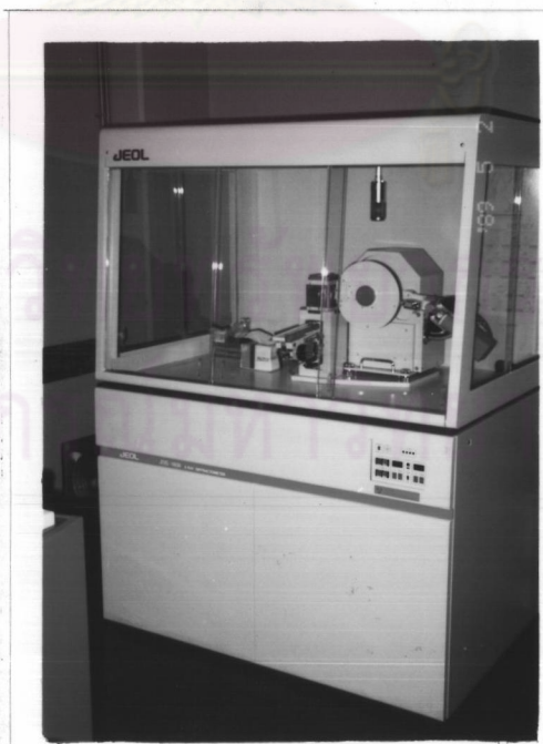
รูปที่ 3.10 เครื่อง x-ray diffractometer ที่ใช้ในการวัดฟิล์มบาง ZnS
