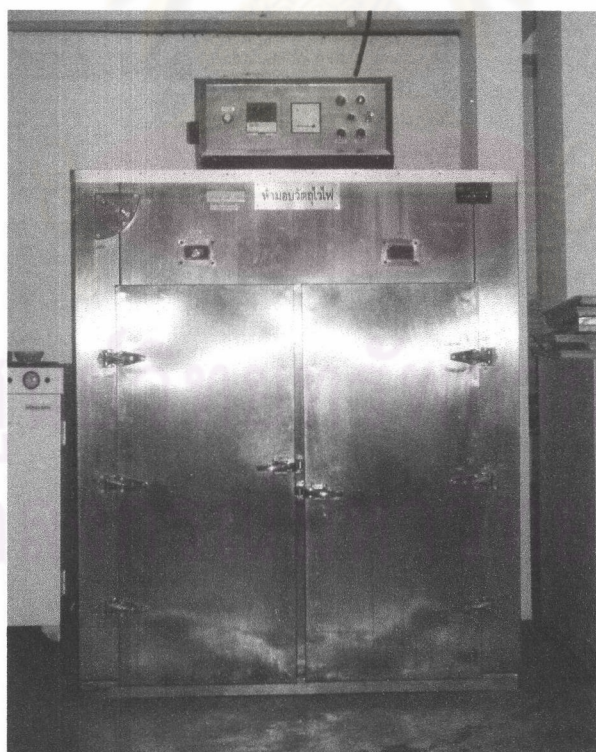
ภาพที่ ค.10 ตู้อบลมร้อนแบบถาด (Tray dryer)
