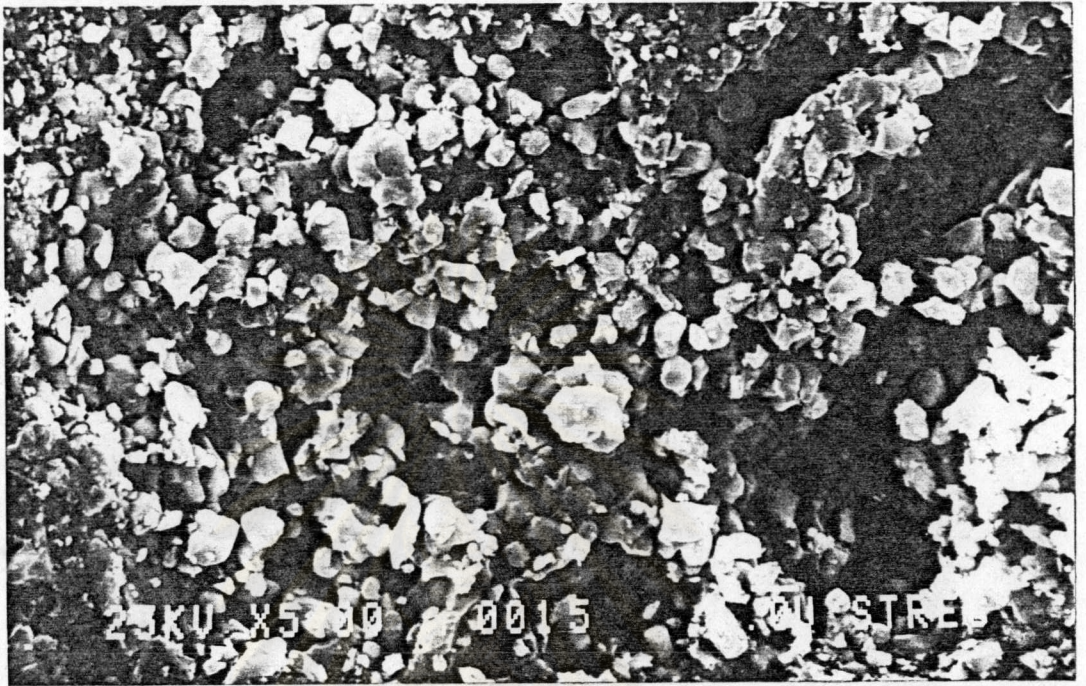
รูป 5.8 (15) ลักษณะโครงสร้างของเม็ดยูเรเนียม ไดออกไซด์ ตัวอย่างที่ 15
