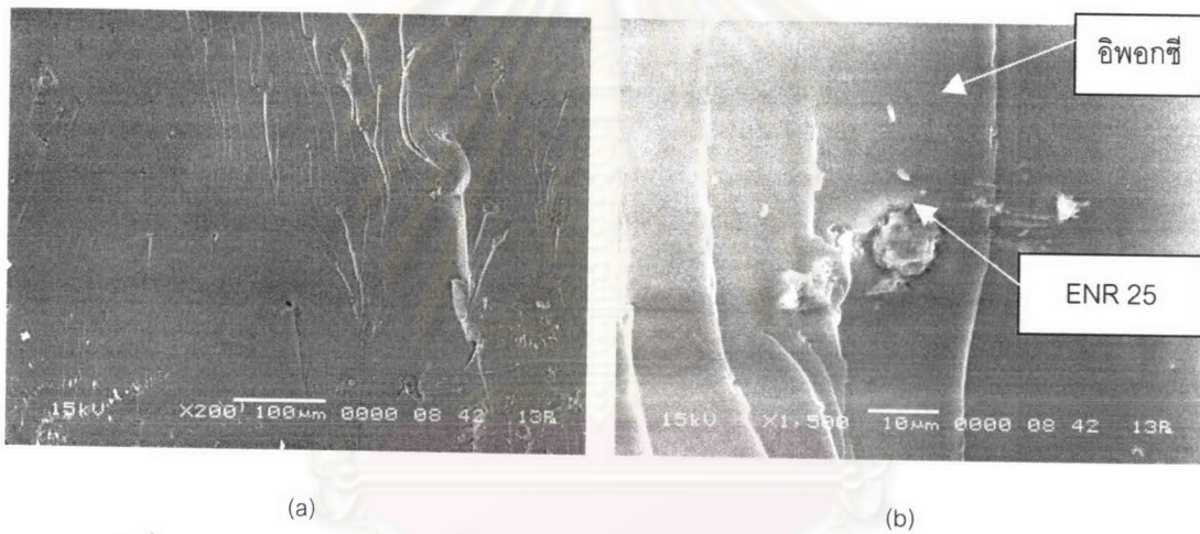
รูปที่ 4.17 สัณฐานวิทยาของพื้นผิวรอยแตกของพอลิเมอร์ผสมระหว่างอิพอกซีเรซินกับ ENR 25 ปริมาณ 10 phr (a) กำลังขยาย 200 เท่า (b) กำลังขยาย 1,500 เท่า
