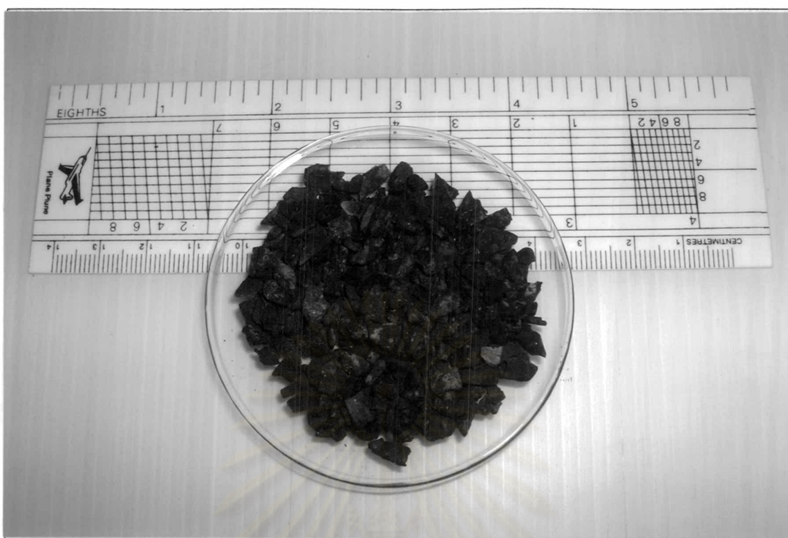
ภาพที่ 3.2 ถ่านเคลือบไคโตแซน ที่ใช้เป็นตัวกลาง
