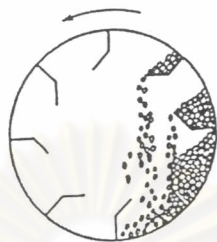
รูปที่ 3.4 Rotary dryer with lifters
