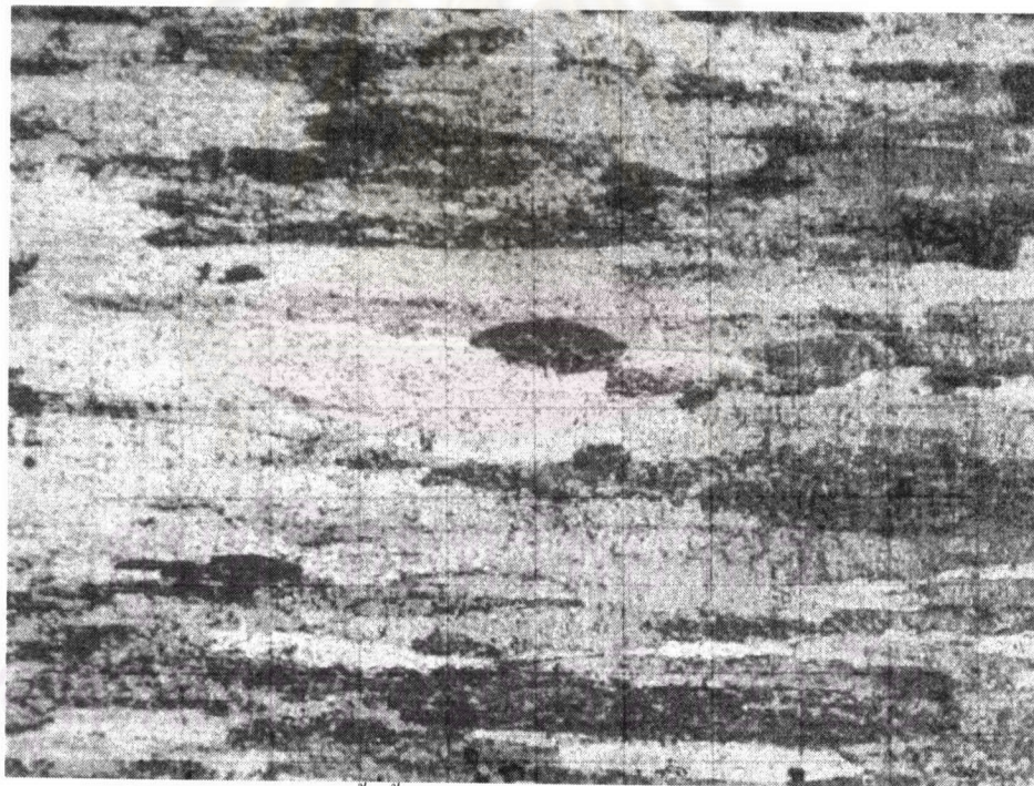
รูป 5.2 แสดงลักษณะเนื้อชิ้นงานแผ่นรีดเย็นมาจากโรงงาน 50X(As-receive)
