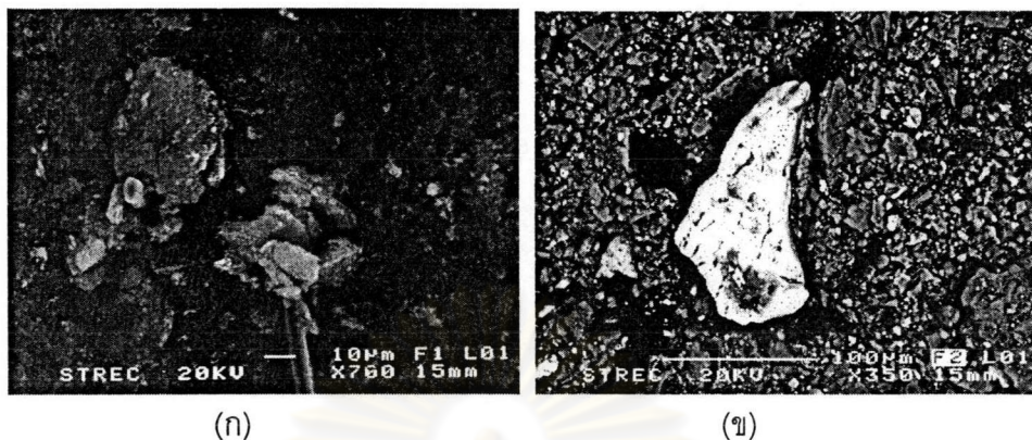
รูปที่ 4.11 ขนาดอนุภาคบนกระดาษคาร์บอน : (ก) ขั้วไฟฟ้าจากบริษัท Electrochem (ข) ขั้วไฟฟ้าจากการเตรียมด้วยวิธีการพิมพ์
