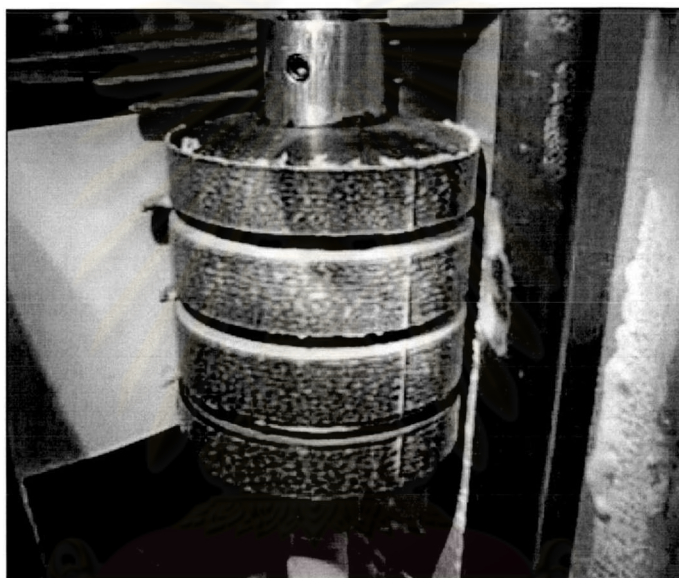
รูปที่ 5.13 ระบบปิดกาวด้วยลูกกลิ้งกาว(ก่อนการทำ Benchmarking)
