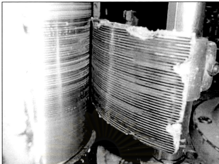
รูปที่ 5.15 ระบบปิดกาวด้วยแป้นการรูปพัดที่ทำด้วยยาง
