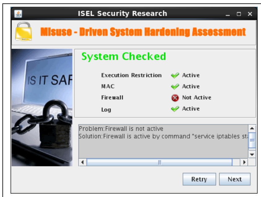
ภาพที่ 6.7 ผลการประเมินระบบที่มีการติดตั้ง iptables แต่ไม่เปิดใช้งาน
