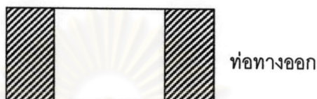
รูปที่ 5.17 สัดส่วนพื้นที่เปิดของพื้นที่ตะแกรง 50% ของพื้นที่หน้าตัดทั้งหมด(มองด้านบน)
