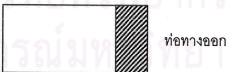
รูปที่ 5.15 สัดส่วนพื้นที่เปิดของพื้นตะแกรง 75% ไกล่ ของพื้นที่หน้าตัดทั้งหมด(มองด้านบน)
