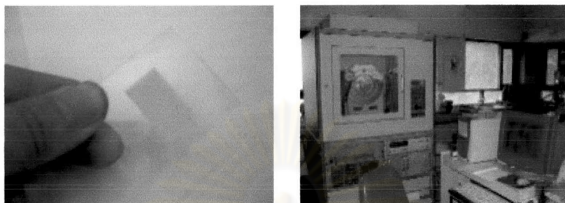
รูปที่ 3.3 การเตรียมแร่เพื่อวิเคราะห์และเครื่องเอกซเรย์ดิฟแฟรกชัน
