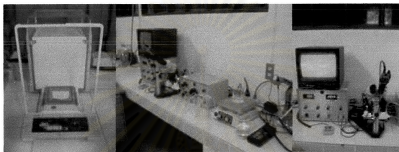
รูปที่ 3.17 เครื่องชั่งน้ำหนักและการเตรียมเครื่อง Zeta Meter และเครื่อง Zeta Meter ที่ใช้ในการทดลอง
