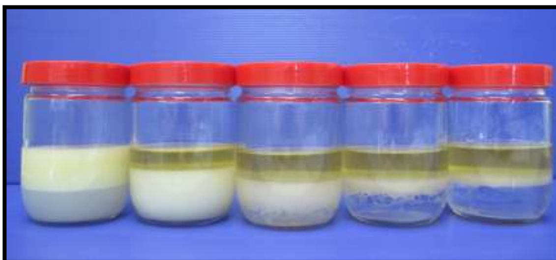
ภาพที่ 4.8 เปรียบเทียบลักษณะทางกายภาพของไบโอดีเซลและน้ำหลังการล้าง
