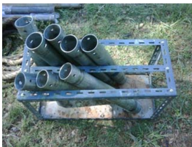
ภาพที่ 3.3 กระบอกล้อเลื่อนบาง (Shelby Tube)
