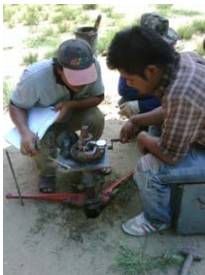
ภาพที่ 3.6 การทดสอบไบมีดสนาม
