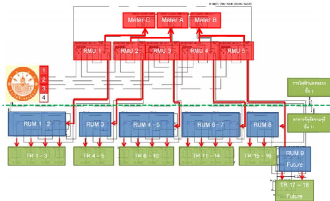
รูปที่ 3.5 โครงสร้างระบบไฟฟ้าแรงสูง (Ring Main Unit)
