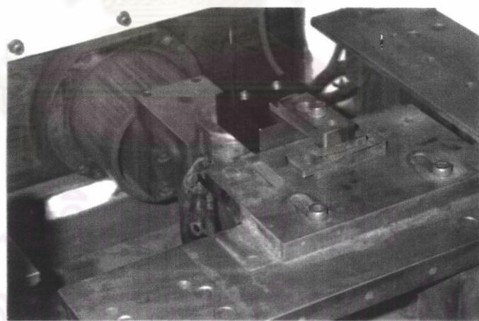
6. นำชิ้นงานที่ได้ทำ wire cut ตามแบบเรียบร้อยแล้วไปทำการเจียร ในให้พิวท์ส่องข้างของชิ้นทดสอบมีความนั่นเงา โดยจะต้องให้รอบขันแมวที่เกิดจากการเจียร ในตั้งฉากกับรอบยก โดยใช้เครื่องเจียร ในที่มีแท่นแม่เหล็กสำหรับจับยึดชิ้นทดสอบ สามารถควบคุมระดับความเร็วของหินและอัตราการหล่อเย็นได้
