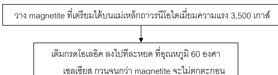
ภาพที่ 3.4 วิธีการป้องกันการรวมตัว (aggregation) ของอนุภาคแมกนีไทต์ ( \text{Fe}_3\text{O}_4 ) (พิชชาภา บุญญคง, 2551)
