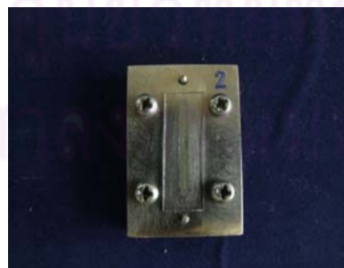
ภาพที่ 19 แสดงขั้นตอนทดสอบเสริมเส้นใยขณะก่อตัวในแบบหล่อโลหะ
