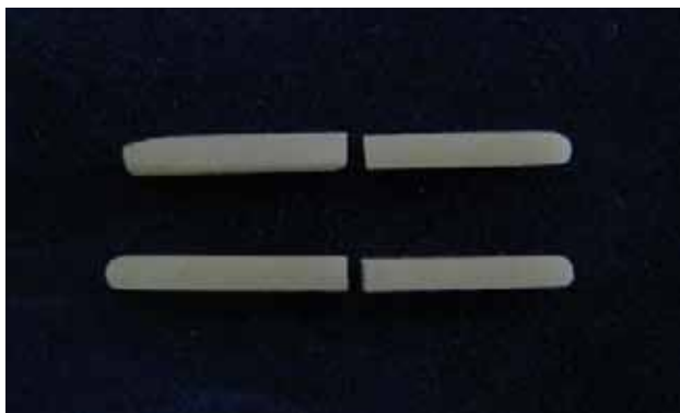
ภาพที่ 42 แสดงชิ้นส่วนที่เกิดการแตกหักภายหลังจากทดสอบของชิ้นทดสอบที่ไม่ได้เสริมเส้นใย
