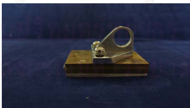
ภาพที่ 22 แสดงแบบหล่อโลหะที่ใช้จับชิ้นทดสอบเพื่อการขัดแต่ง
