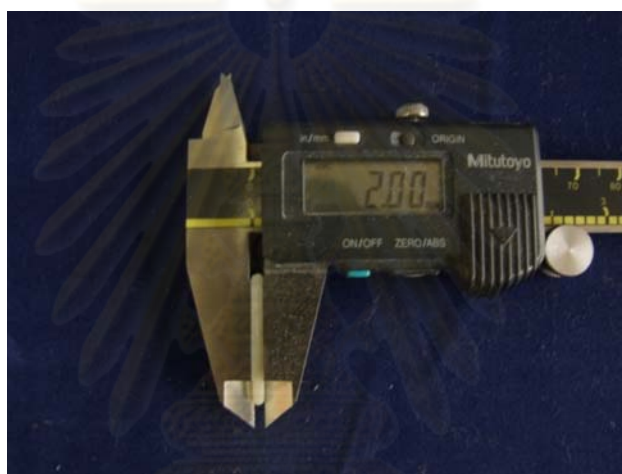
ภาพที่ 21 แสดงการวัดขนาดชิ้นทดสอบด้วยเครื่องวัดขนาดแบบดิจิตอล
