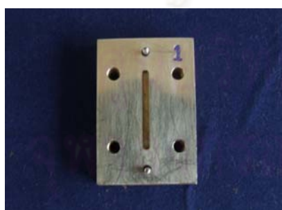
ภาพที่ 10 แสดงส่วนประกอบด้านบนและด้านข้างของแบบหล่อโลหะในขั้นที่ 1
