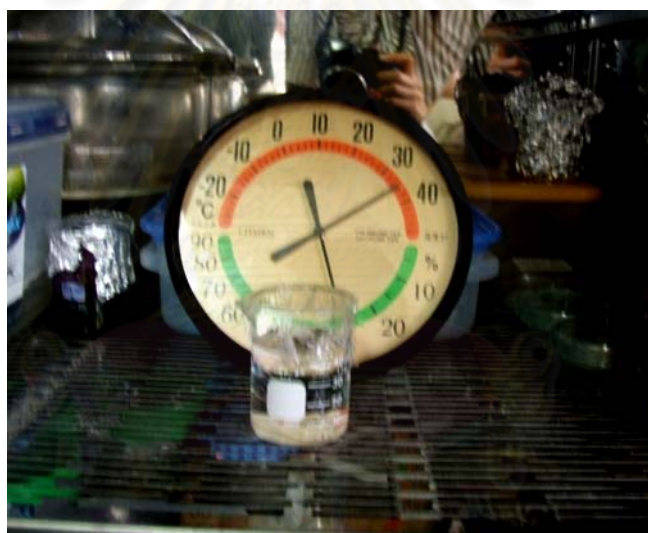
ภาพที่ 24 แสดงการแช่ชิ้นทดสอบในน้ำกลั่นภายใต้อุณหภูมิ 37 องศาเซลเซียสในตู้ควบคุม อุณหภูมิ
