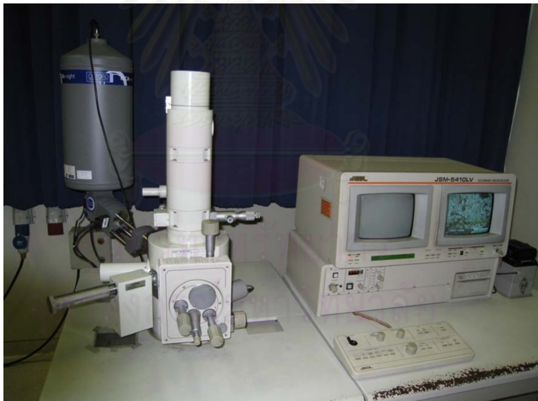
ภาพที่ 29 แสดงกล้องจุลทรรศน์อิเล็กตรอนแบบส่องกราด (JEOL, JSM 5410LV, Tokyo, Japan)
