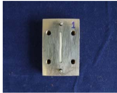
ภาพที่ 17 แสดงการวางเส้นใยแก้วตามแนวยาวของชั้นทดสอบ
