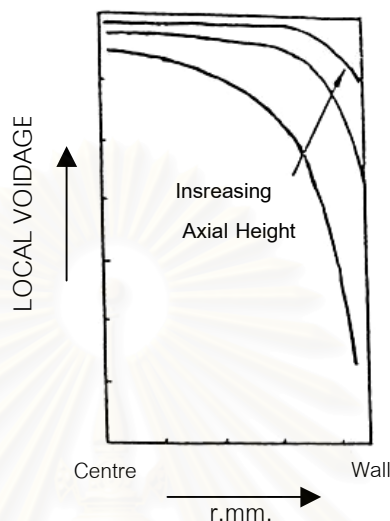
รูปที่ 2.22 สัดส่วนช่องว่างตามแนวรัศมีของระบบ fast bed (4)
