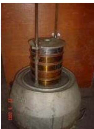
รูปที่ 3.13 เครื่องร่อนและตะแกรงร่อนแยกขนาด
