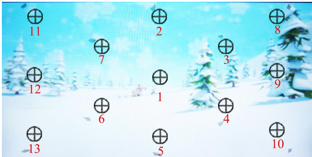
ภาพที่ 3.5 แสดงตำแหน่งการวัดค่าความสว่างจอ 250 cd/m 2 ตารางที่ 3.1 แสดงผลการวัดค่าความสว่างจอ 250 cd/m 2 โดยลูมิแนนซ์มิเตอร์
