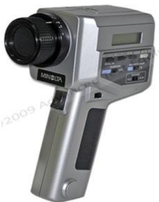
ภาพที่ 3.1 แสดงลูมิแนนซ์มิเตอร์
