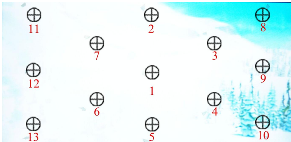
ภาพที่ 3.6 แสดงตำแหน่งการวัดค่าความสว่างจอ 250 cd/m 2
