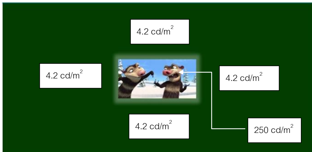
ภาพที่ 3.19 ภาพแสดงตัวอย่างจอ LED โดยการทดสอบการวัดความสว่างพื้นหลัง 4 จุด
