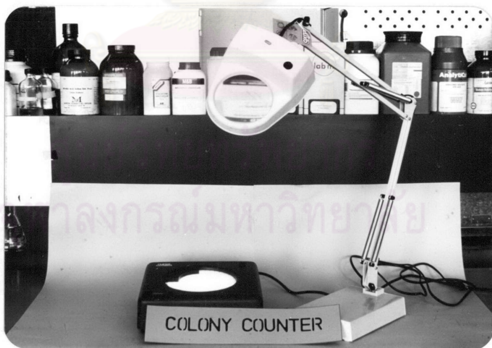
รูปที่ 11 เครื่องตรวจนับจำนวนโคโลนี (Colony Counter)
