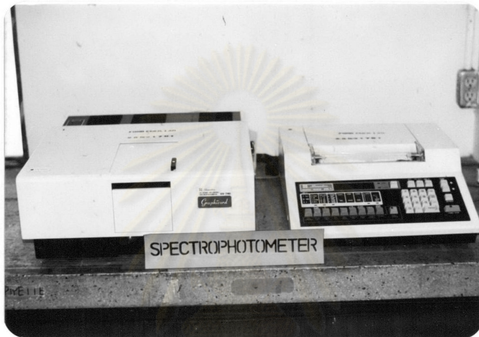
รูปที่ 18 Spectrophotometer ของ Shimadzu รุ่น UV 240
