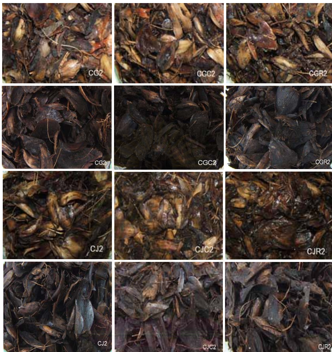
รูปที่ 4.35 แสดงลักษณะของปุ๋ยหมักที่มีการแปรผันแหล่งไนโตรเจนในชุดการทดลองต่างๆ ครั้งที่ 2 เมื่อเริ่มต้น 0 วัน (แถวที่1 และ3) เมื่อสิ้นสุดการหมักเป็นเวลา 35 วัน (แถวที่2 และ4)
