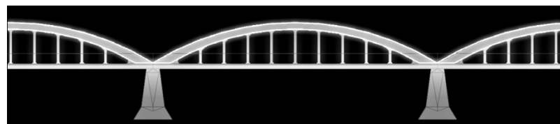
การส่องสว่างดวยการใช้ดวงโคมมุมลำแสงแคบส่องเน้นโครงตั้ง
