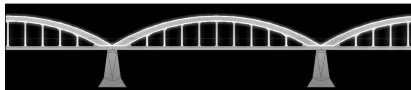
การส่องสว่างดวยการใช้ดวงโคมมุมลำแสงแคบส่องเน้นโครงตั้ง
