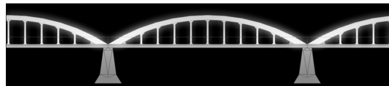
การส่องสว่างดวยการใช้ดวงโคมมุมลำแสงแคบส่องเน้นโครงตั้ง
