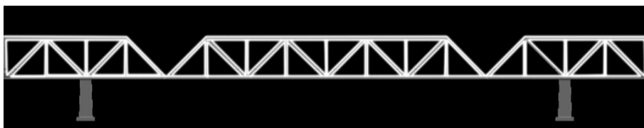
ภาพที่ 5.2.9 การส่องสว่างสะพานโครงถักโดยการใช้ rope light
