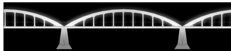
การส่องสว่างดวยการใช้ดวงโคมมุมลำแสงแคบส่องเน้นโครงตั้ง
